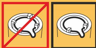
Вокруг верхней кромки тигля необходимо создать равномерный зазор, для чего использовать картон или древесную щепу. Не допускается использовать клинья из огнеупорного материала.
