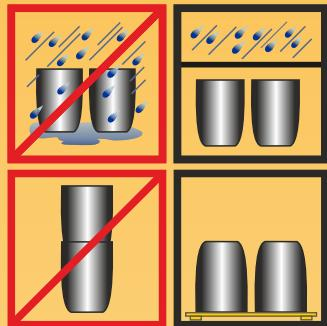
Хранить тигли в сухом, хорошо проветриваемом помещении на деревянных подставках.
