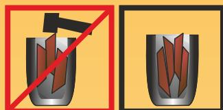
Слитки металла следует укладывать в тигель вертикально, исключая заклинивание отдельных кусков.
