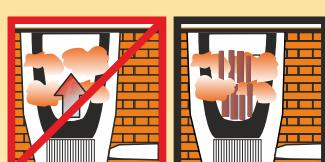
Между плавками не оставлять тигель в печи пустым. Период между плавками должен быть минимальным.
