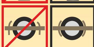
В печах сопротивления и индукционных печах зазор между кромкой тигля и кожухом печи следует замазать смесью на основе огнеупорной глины.
