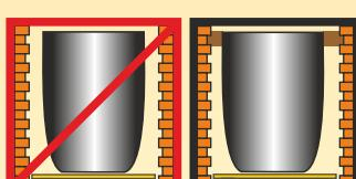
В индукционных печах пространство между тиглем и индуктором заполняется изоляционным материалом.
