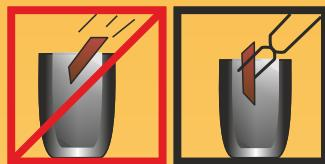
Металл загружать только в разогретый тигель. Металл должен быть сухим и слегка подогретым. Большие куски следует вводить в тигель клещами, не допуская их соударений с тиглем. Сначала загружаются мелкие куски, а затем отливки.
