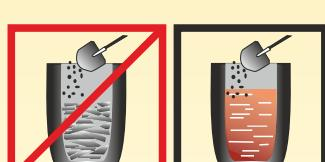
Вводить добавки только в расплавленный металл.
