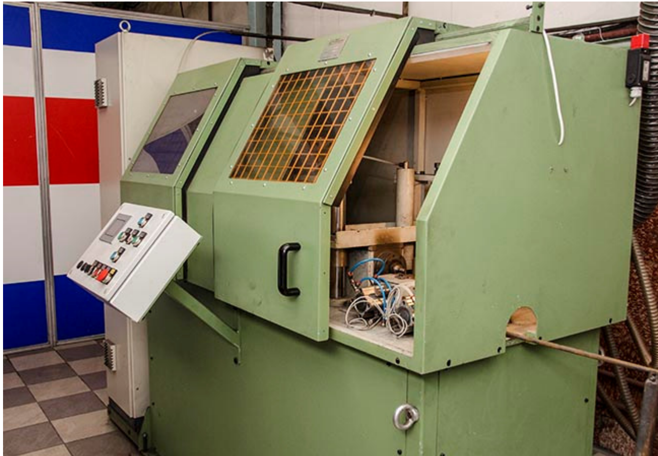
Станок RoggiPosqualino, на котором производился тест отрезных кругов для УШМ.
